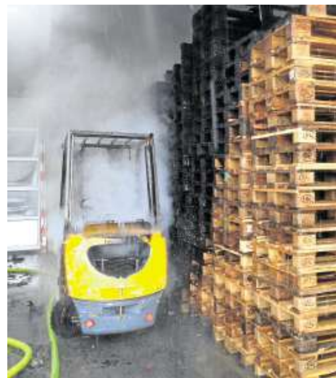
Die Elektrik dieses Gabelstaplers hat nach Einschätzung der Experten versagt und zum Brand geführt.
